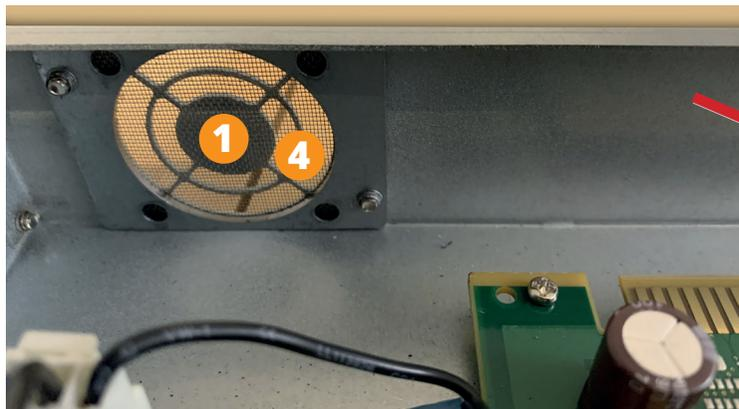
Lüfterbefestigung ausbauen. Dabei beachten, dass der Metallfilter nicht beschädigt wird.
