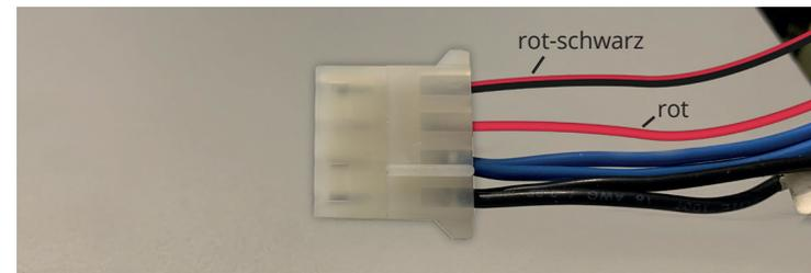
Die beiden Pins des Lüfters am Stecker der Mainboard-Stromversorgung wie abgebildet einstecken, bis diese eingerastet sind. Ein nachträgliches Lösen ist mit einem Molex Pin-Ausdrücker möglich.
