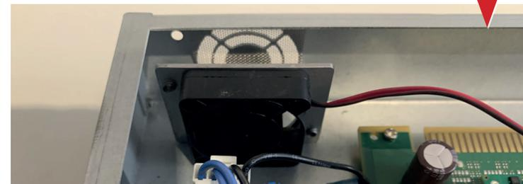
Richtigen Sitz des Metallfilters prüfen und Lüfter einschrauben. Gehäuse wieder zusammenbauen.
